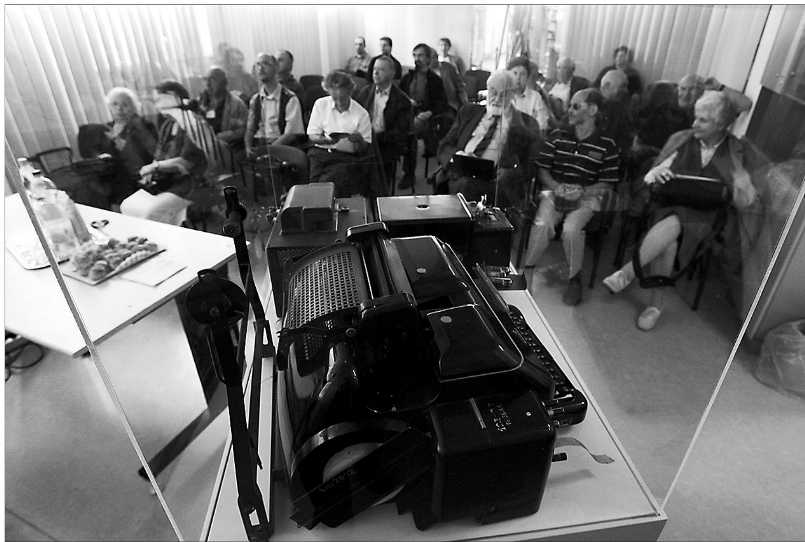
A távgépíró, amellyel az M-3 számítógépbe táplálták az adatokat. A szovjet dokumentáció nem szólt a perifériákról
