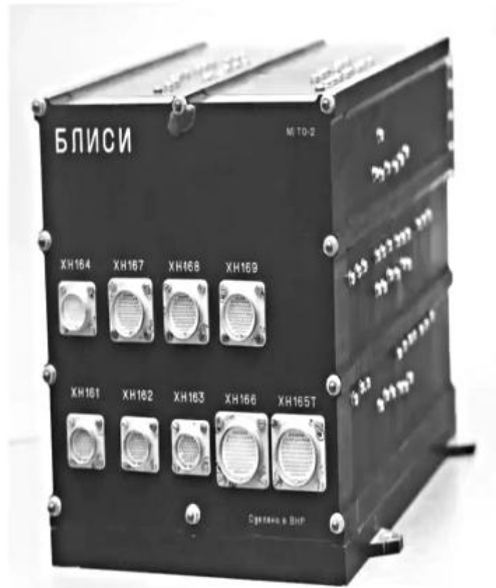
A VEGA-szondák adatgyűjtő berendezése (BLISZI), amelyet fővállalkozásban a BME szakemberei készítettek a KFKI/RMKI szakembereivel együttműködésben (VEGA-program, BME, KFKI/RMKI).
