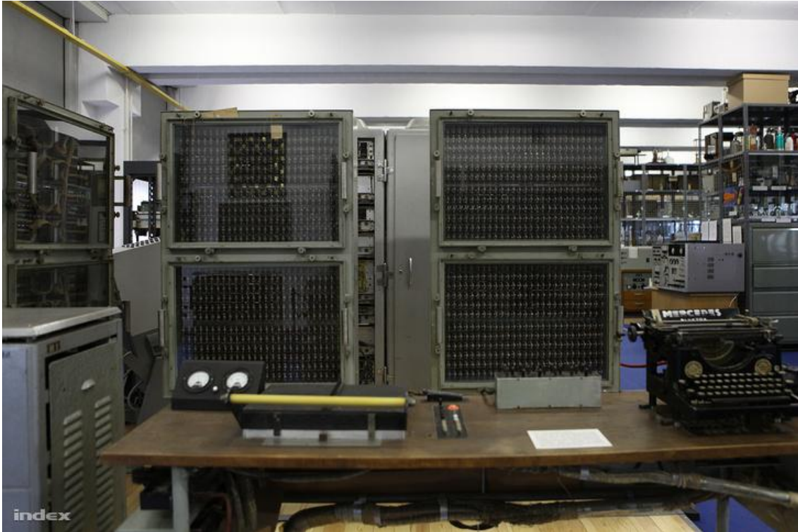
A Kozma László által tervezett MESz-1, azaz "Műegyetemi Számológép-1" jelfogós számítógép. (Fotó: Nagy Attila)
