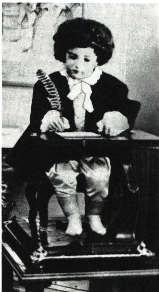
29. ábra Az írnot negyven betűből álló tetszés szerinti szövegre lehet programozni (lásd az írásmintát). A hozzá nagyon hasonló rajzólónál a több fogaslécből álló vezérlő berendezés segítségével sok rajz készíthető. (Lásd még a 30. ábrát)
