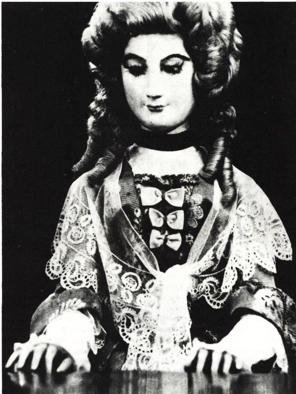
28. ábra Az orgonajátékosnő, a Jaquet-Droz család három automatája közül az egyik, amely ha bekapcsolják először lélegzetet vesz, a teremben körülnéz, de egyelőre nem játszik. Ha végül művészetével megadományoz bennünket, tekintetét a kottára koncentrálja, s gép-ujjai valódi hangszerezen játszanak
