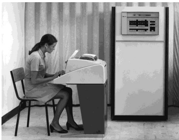
A CII 10010 szekrényes alapkiépítésben az ASR 33-as konzollal
