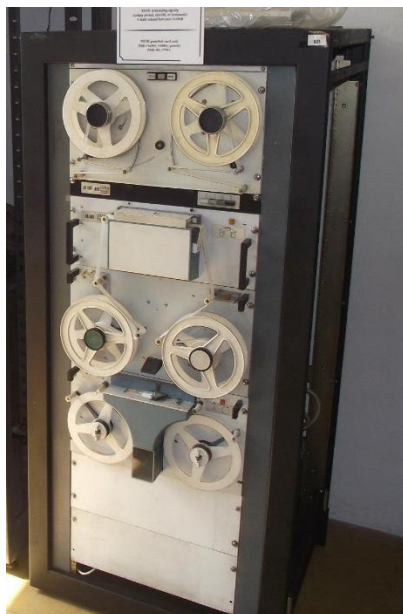
Szekrénybe épített lyukszalag olvasó- lyukasztó és csévlő
