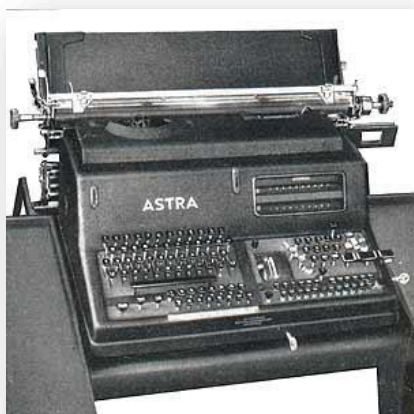
ASTRA 8, 1940. (19 gyűjtőmű, 60 cm könyvelőkocsi, dátum, szimból, egyenlegválogatás, írógép, kocsi visszafutás)
