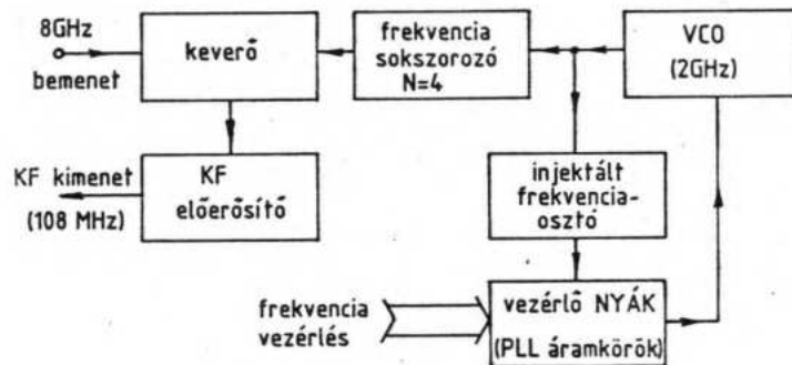
2. ábra: 8 GHz-es vevőegység
