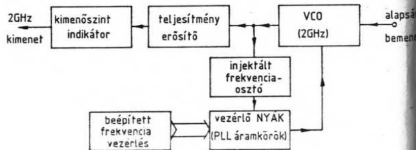
3. ábra: Központi állomási adóegység
