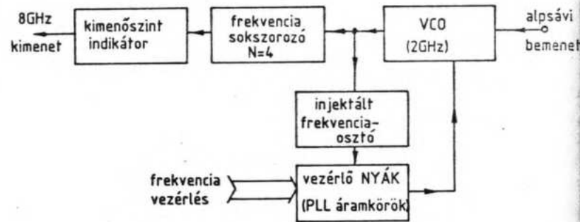
1. ábra: 8 GHz-es adóegység
