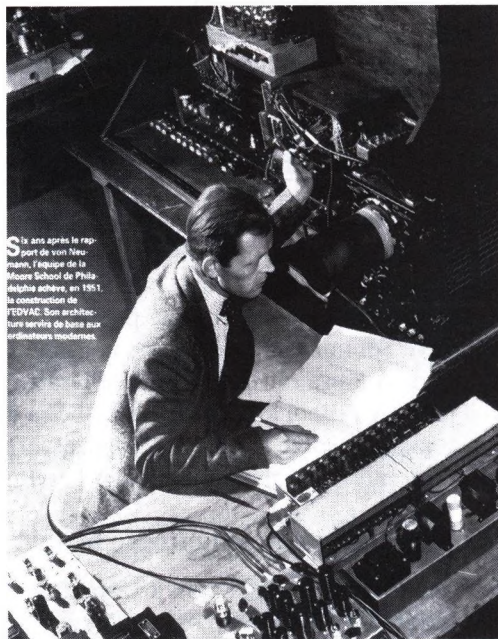
6. ábra. Az EDVAC, a Moore School-ban tervezett második, de már tárolt programú, soros működésű, elektronikus (elektroncsöves) számítógép. (1945)
