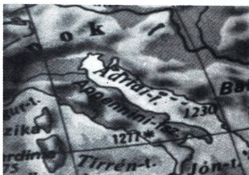
17. kép. Geometriai korrekció: a) bemenő kép (korrigálandó), b) referenciakép, c) kimenő kép (korrigált)
