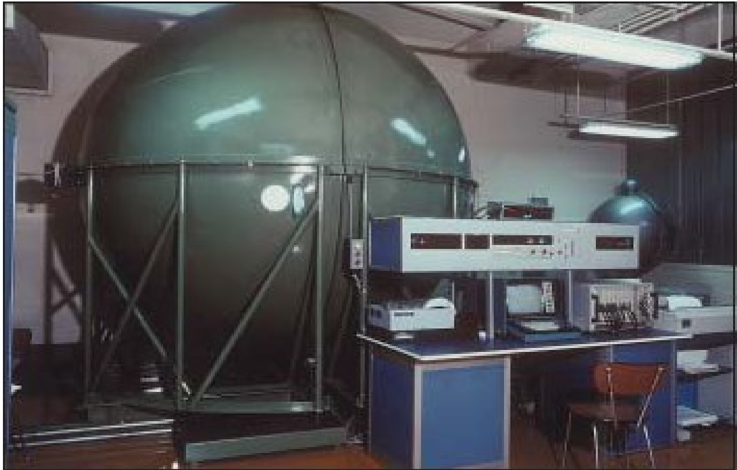
19. kép Fényforrás-karakterizáció mérés Intelligens CAMAC-kal a Tungsram Rt-ben
