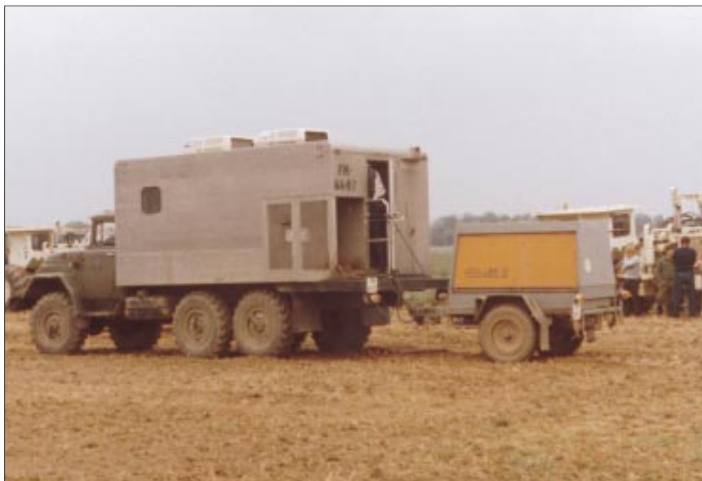
136 CFS-I/DFS-IV műszerkabin Zil-131 teherautón (1977-80-as évek végéig)
