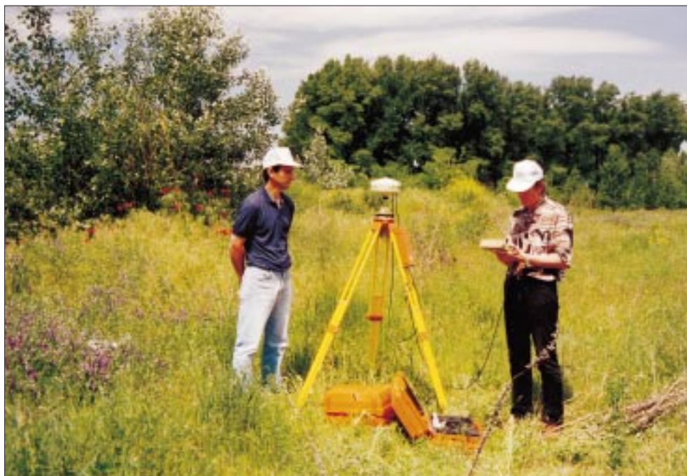
127 Az alappontok beméréséhez használt statikus Wild GPS System 200 műszer (Lakatos László és Wenner László geodéta mérnökök, 1994)
