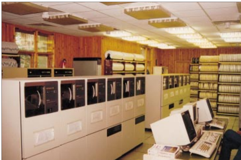
181 A Cyber számítógép (GeoMaster rendszer) mágnesszalagegységei és vezérlőpultja (1988-1996)
