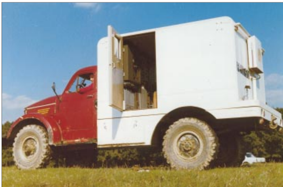
133 DFS-III műszerkabin, Gaz-63-as teherautón (1972-1984)
