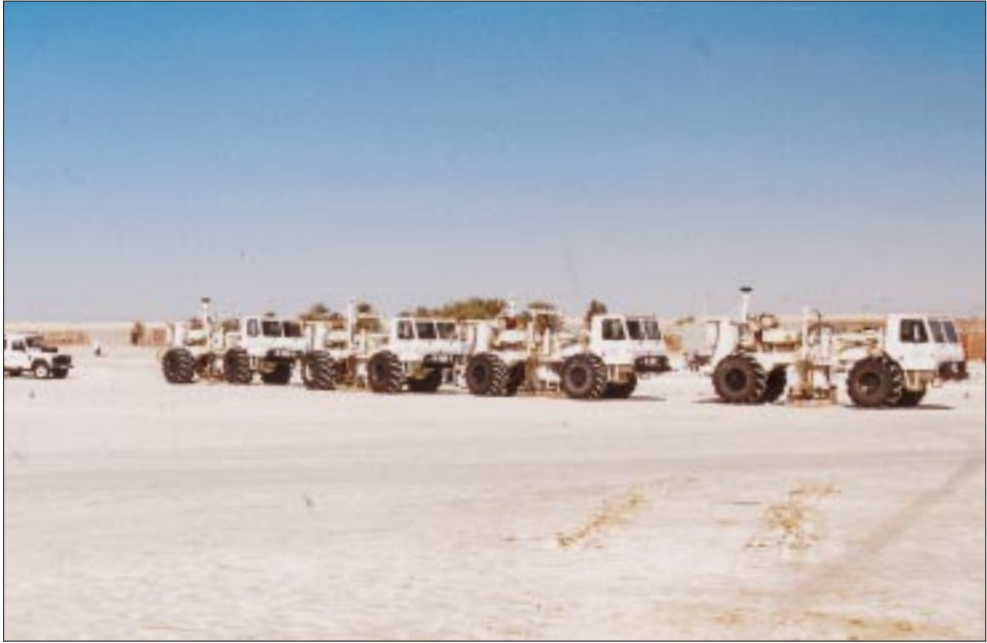
165 GES (Failing Y-2400) vibrátorok a tunéziai chott el Jerid-en (időszakos sós tó, 1992)
