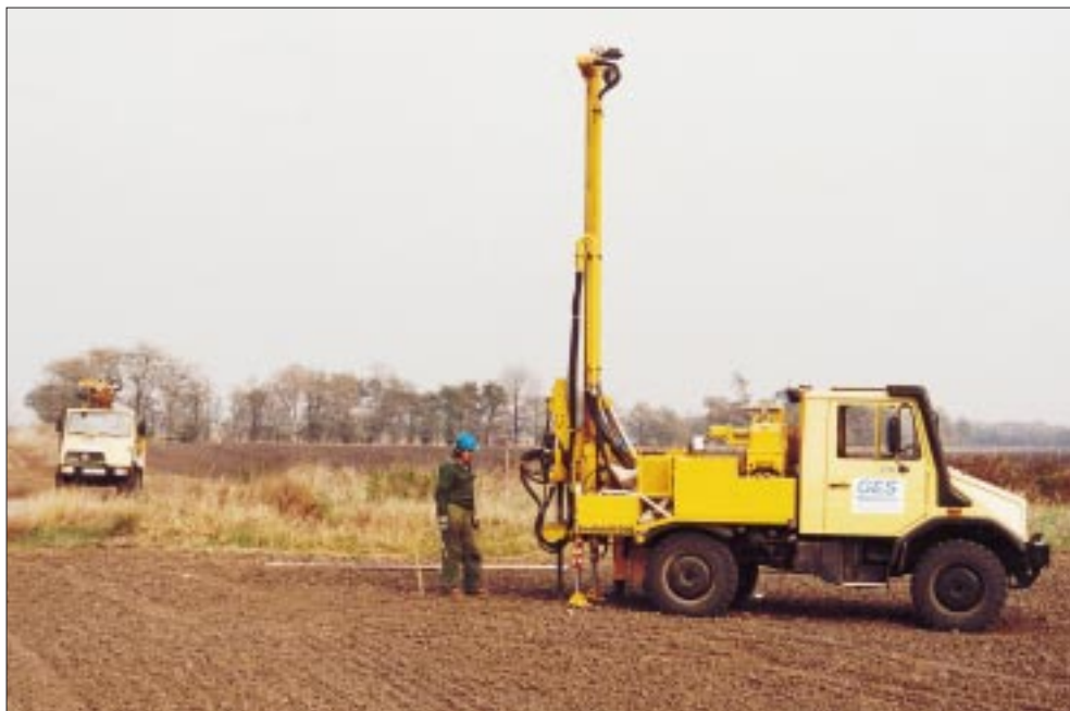
145 Unimog teherautóra szerelt korszerű Sedidril fúrógépek (1996, Sólyom Imre)
