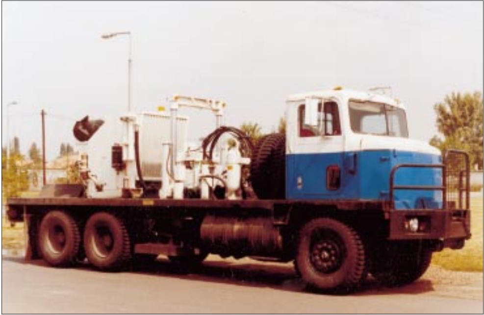
151 Bird teherautóra szerelt, VSP mérésekhez használt Failing Y-2400 vibrátor (1989)
