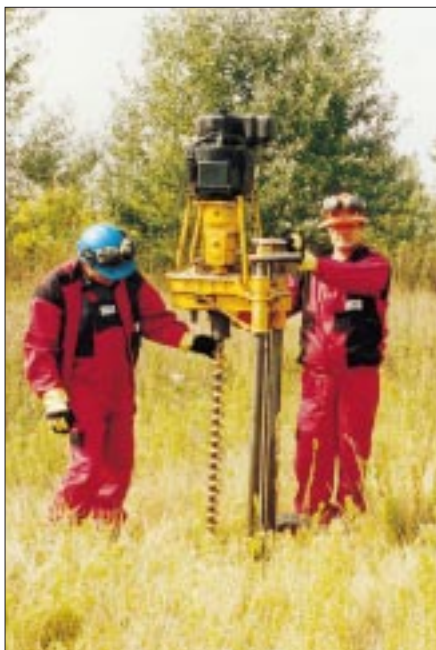
146 Minuteman kézi fúrógép munkában (1996, Bonti Ferenc és Némédi V. László)
