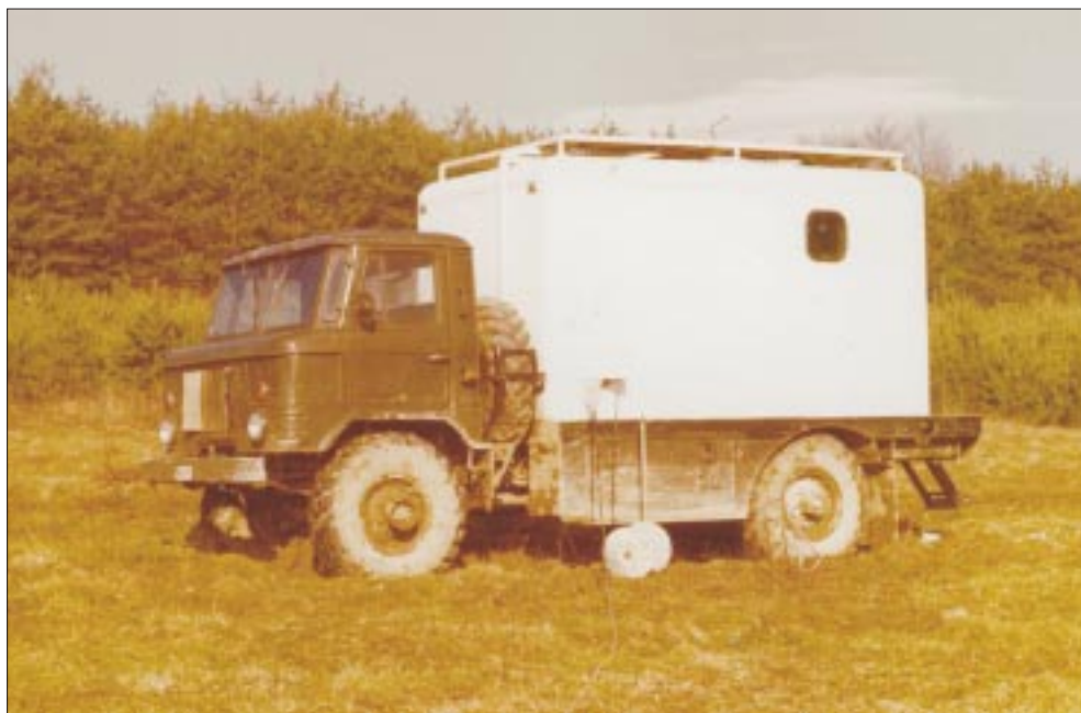
135 DFS-IV műszerkabin Gaz-66 teherautón (1975-90)
