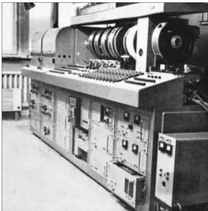
178 A francia (Sercel) gyártmányú CS-621 analóg feldolgozó központ (1966-1971). Az analóg felvételek digitális átjátszásához még 1977-ig üzemben volt.
