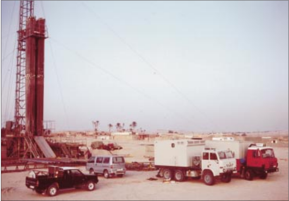
169 VSP mérés színhelye, középen a GES MDS-18 műszerkocsija (Kebili, 1995)
